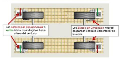
Un chock por rueda, la palanca viendo hacia afuera del vehículo.
