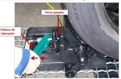
Jale la Palanca de Liberación hacia atrás para desacoplar el Perno Pasador.
