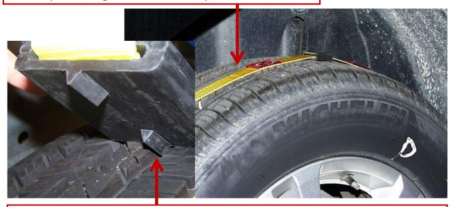
Asegúrese que las costillas de las Cuñas de Retención aseguren el dibujo de la llanta.
