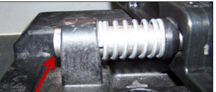
**INCORRECTO:** El Perno Pasador **se extiende más allá** del buje del perno y no está completamente acoplado.
